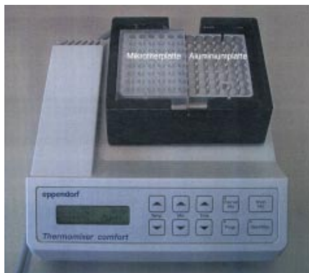
Abbildung 5. Kommerziell erhältlicher Eppendorf-Schüttler mit modifizierter Aluminiumplatte, auf welche die Mikrotiterplatte gesetzt wird (zur besseren Verdeutlichung ist die halbe Aluminiumplatte unbedeckt). [61, 63]
